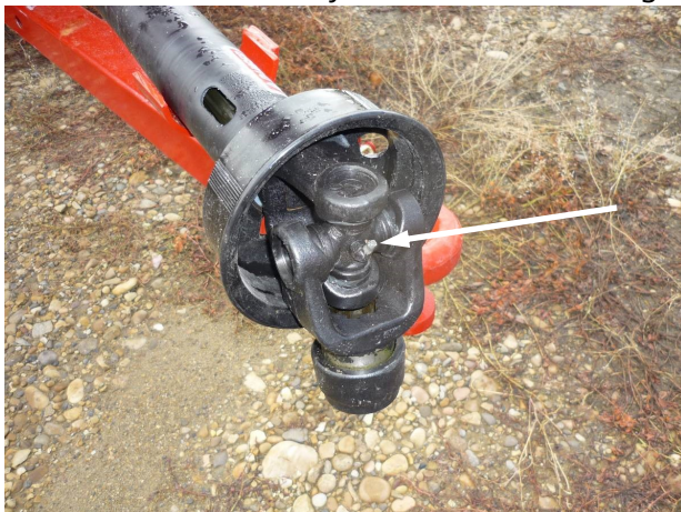
PTO, au milieu : graisser la zerk - étendre le PTO et faire pivoter le bouclier pour trouver la zerk (toutes les 8 heures)
