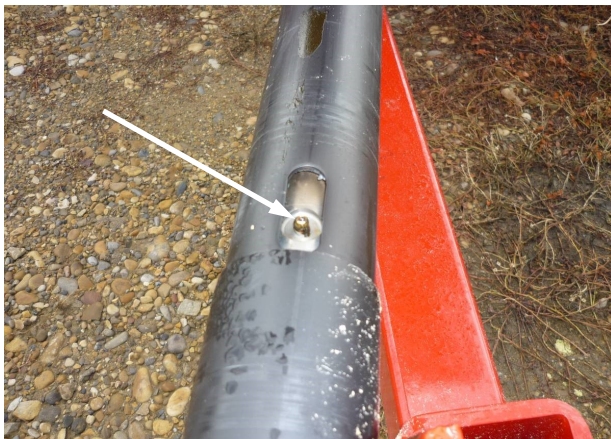
PTO, au milieu : graisser la zerk - étendre le PTO et faire pivoter le bouclier pour trouver la zerk (toutes les 8 heures)
