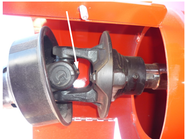
Roulements de l'arbre principal : graisser la zerk avant et arrière (toutes les 50 heures)
