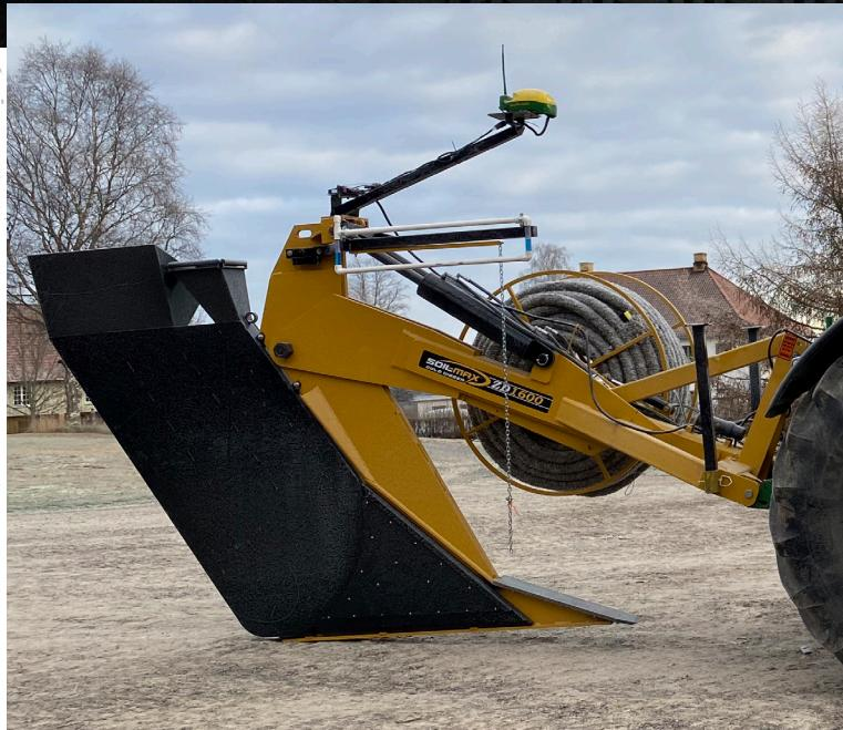
La draineuse ZD1600 Soil-Max® Stealth ZD® offre un avantage supplémentaire avec son caisson rétrécissant, qui lui permet de s'adapter à toutes les exploitations. La ZD1600 est disponible avec l'option supplémentaire d'alimentateur de drains contrôlé par PWM.
